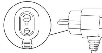
**3** Pritisnite dugme TEST na RCD-u. Krug bi sada trebao da bude crn. To znači da RCD funkcioniše ispravno. Ako pritiskanje dugmeta TEST ne promjeni krug u crnu boju, obratite se korisničkoj službi.
