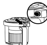
**10** Da biste uklonili poklopac, pritisnite dugme za otključavanje poklopca i okrenite poklopac u suprotnom smjeru od kazaljke na satu.
